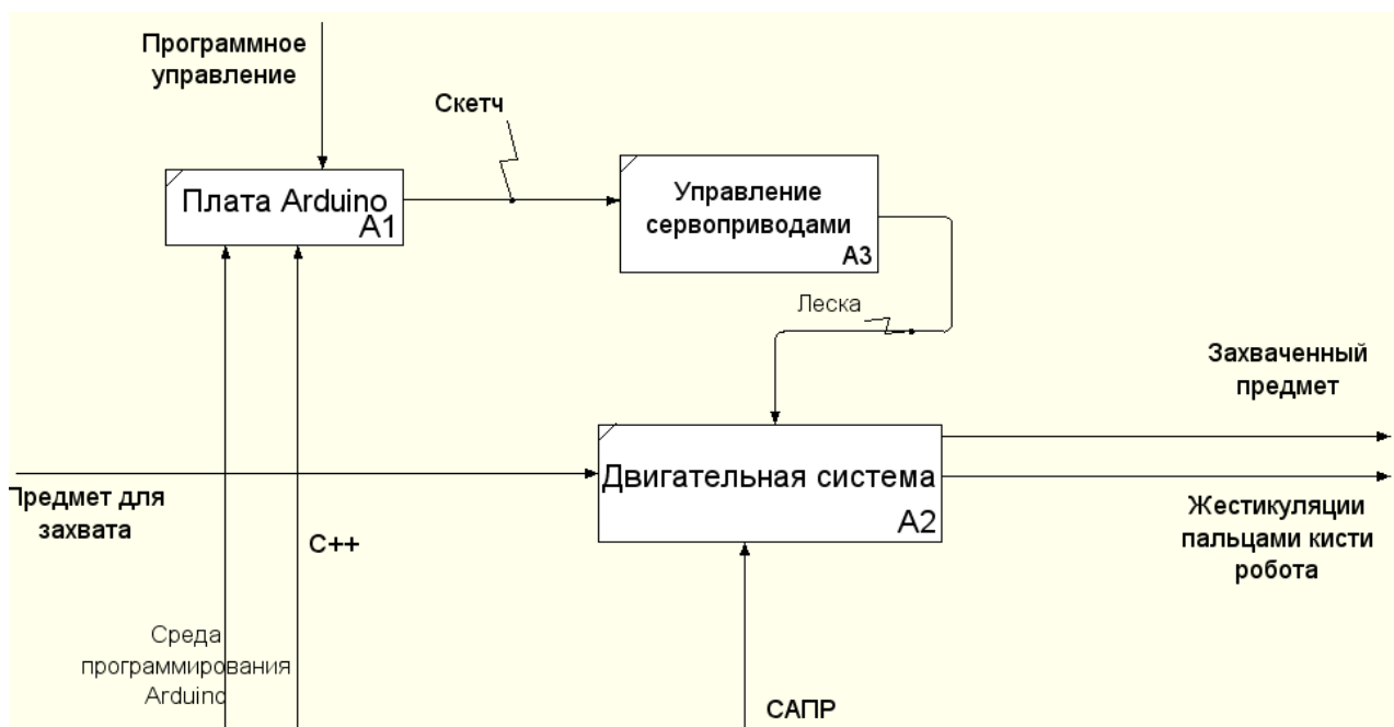
Рис. 2. Декомпозиция диаграммы функциональной модели информационной робототехнической системы
